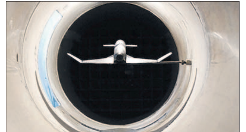
Die „Enterprise“ bei einem Test im Windkanal.
